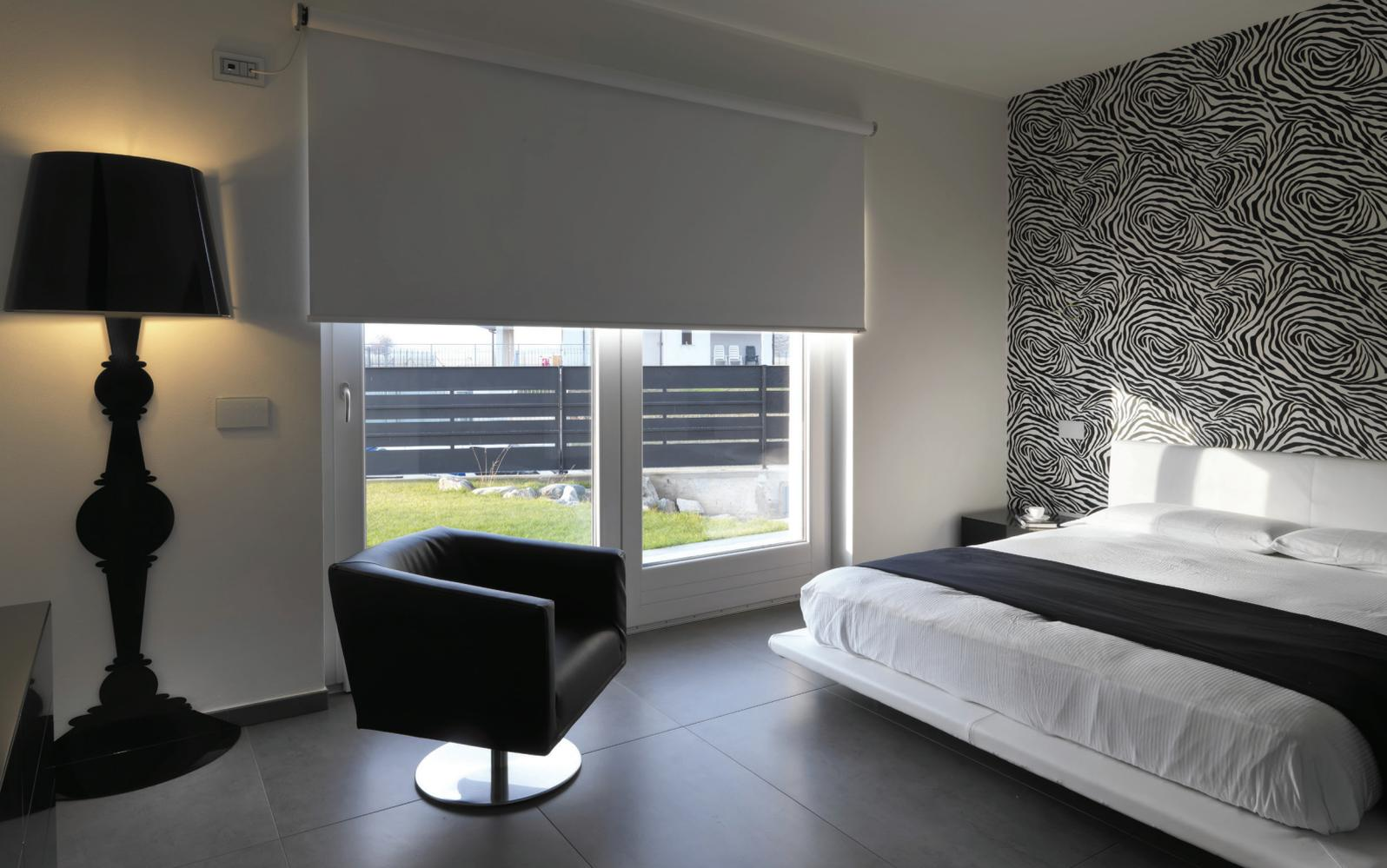
**Отражающие солнечный свет** и тепло роллеты пропускают свет и в то же время эффективно защищают от жары. Ткани, покрытые алюминием или специальным материалом PERLEX, отражают солнечные лучи и таким образом уменьшают воздействие солнца в течение дня и предотвращают нагрев помещения.
